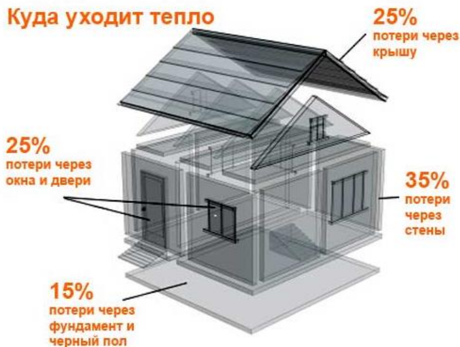
Рис.2 – Структура потерь тепловой энергии через ограждающие конструкции
