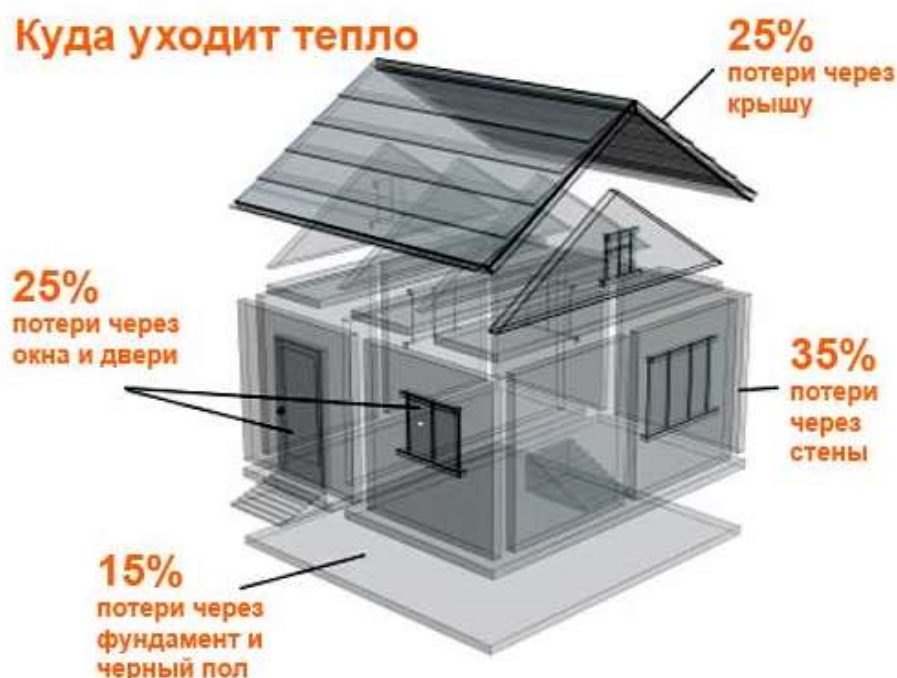
Рис.2 – Структура потерь тепловой энергии через ограждающие конструкции
