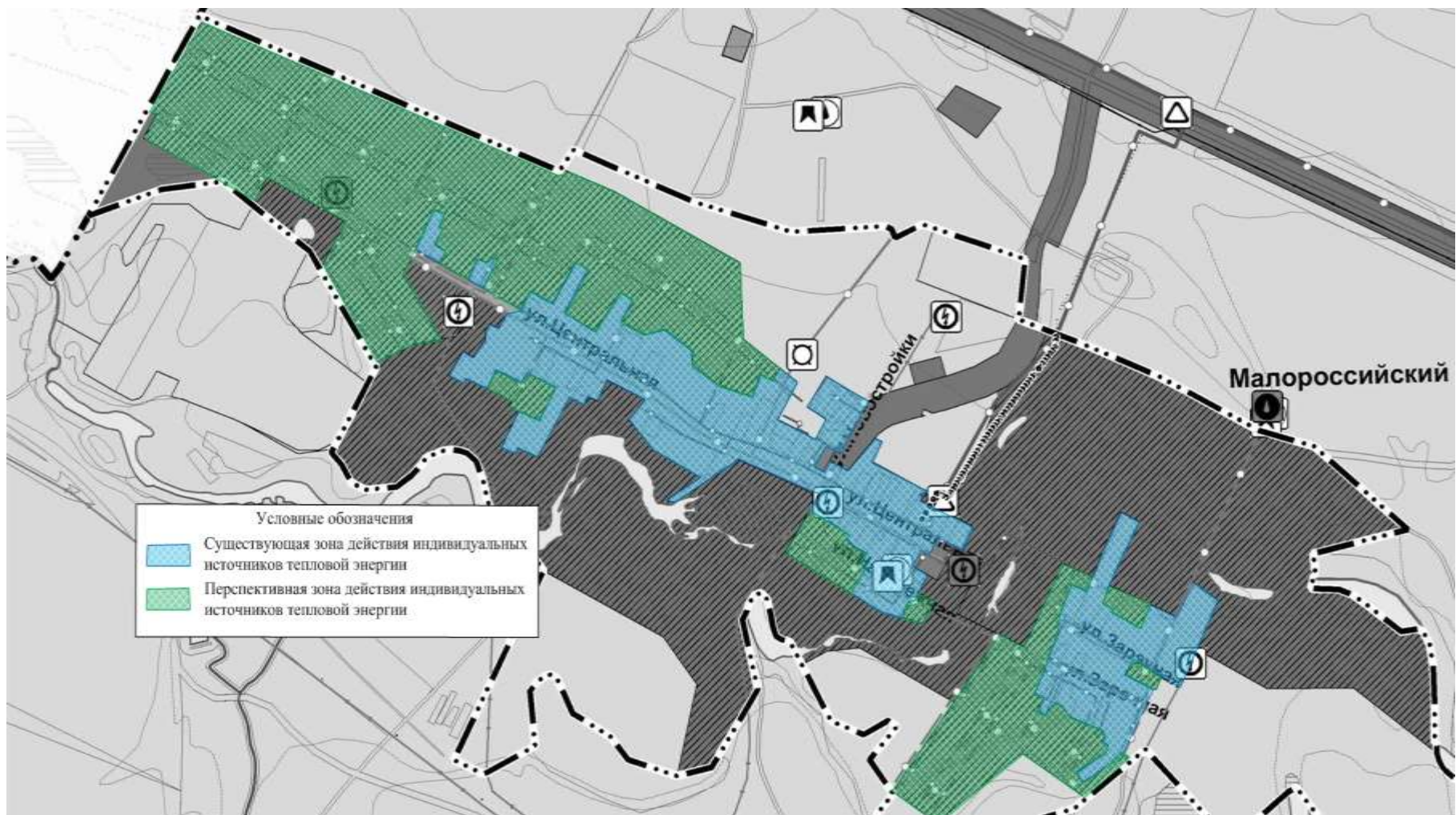
Рис. № 24 - Существующие и перспективные зоны действия индивидуального теплоснабжения на территории п. Малороссийский
