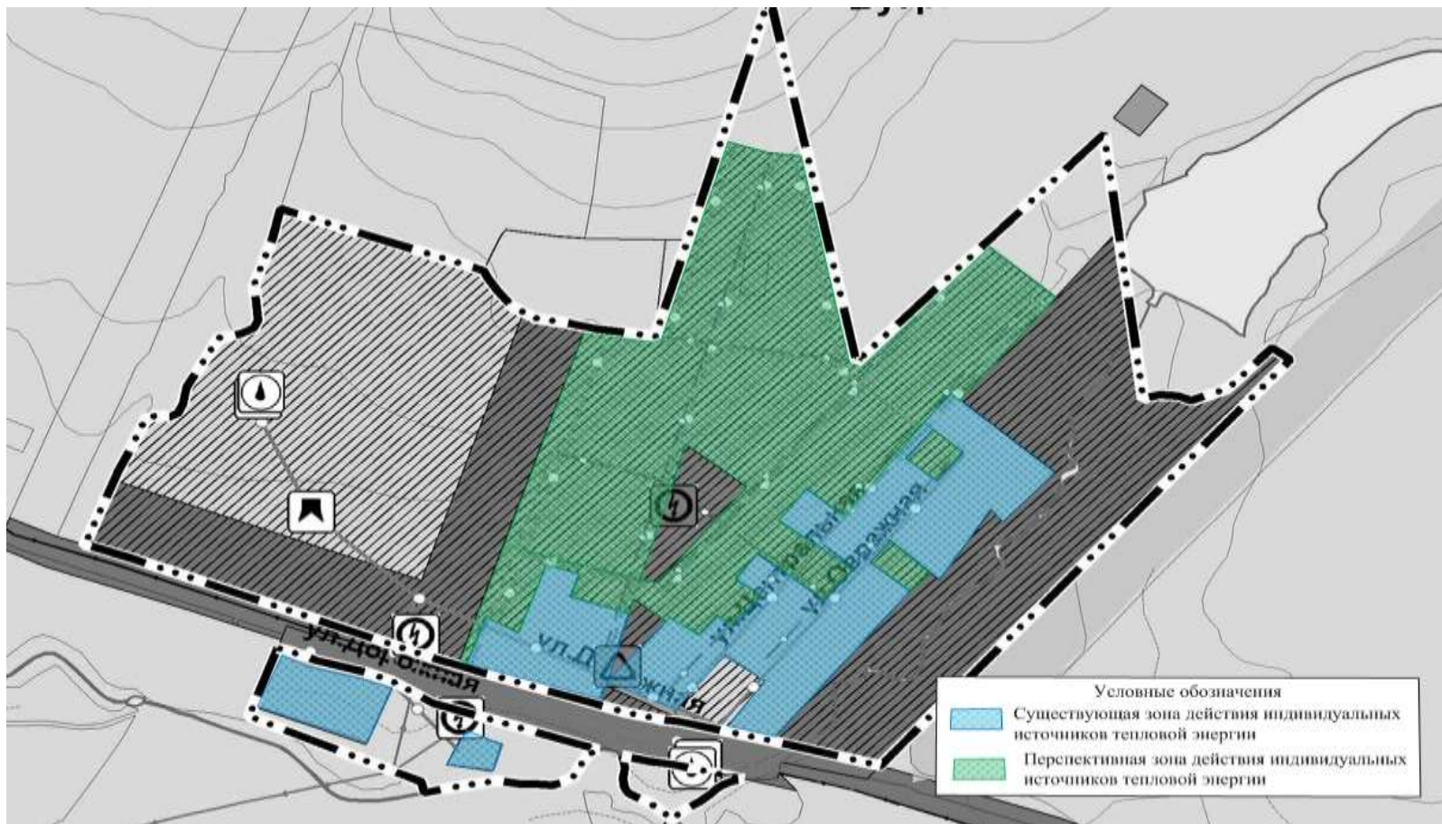
Рис. № 28 - Существующие и перспективные зоны действия индивидуального теплоснабжения на территории п. Бугринка
