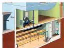
**Противорадиационное укрытие** — защитное сооружение гражданской обороны, предназначенное для защиты уязвимых от воздействия ионизирующей излучений при радиоактивном заражении (загрязнении) местности и допускать непрерывное пребывание в нем уязвимых в течение нормативного времени.
