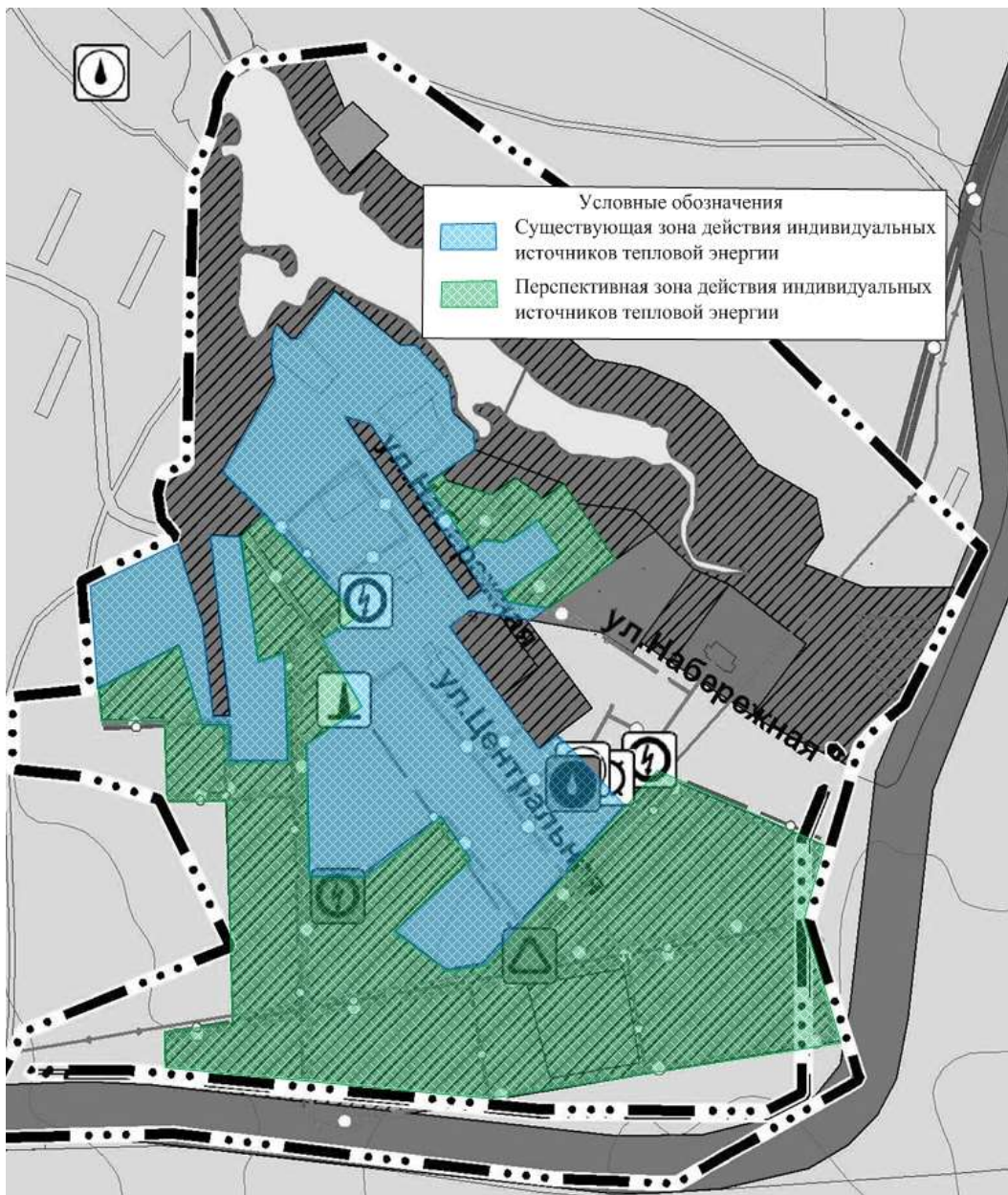
Рис. № 29 - Существующие и перспективные зоны действия индивидуального теплоснабжения на территории п. Кочевой
