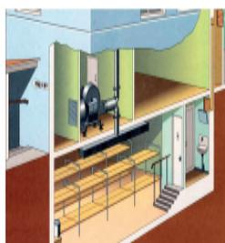
**Противорадиационное укрытие** — защитное сооружение гражданской обороны, предназначенное для защиты укрываемых от воздействия ионизирующих излучений при радиоактивном заражении (загрязнении) местности и допускающее непрерывное пребывание в нем укрываемых в течение нормативного времени.
