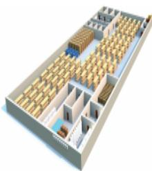
**Убежище** — защитное сооружение гражданской обороны, предназначенное для защиты укрываемых в течение нормативного времени от расчетного воздействия поражающих факторов:
