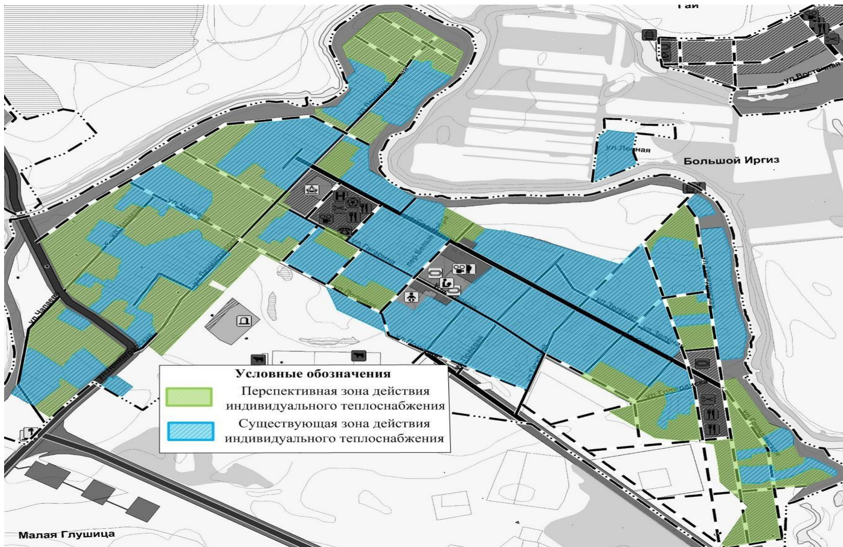
Рис. № 11 - Существующие и перспективные зоны действия индивидуальных источников тепловой энергии на территории села Малая Глушица
