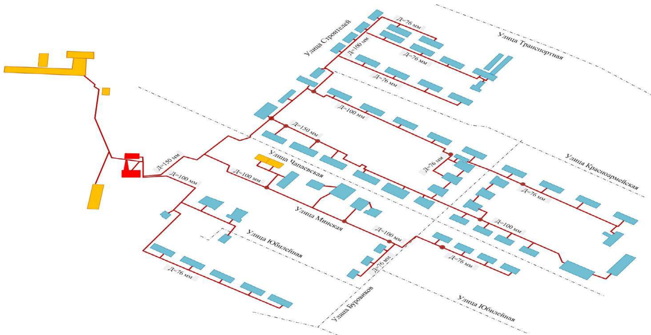
Рисунок 1.3.2.9 - Принципиальная схема тепловых сетей Котельной № 8 в селе Большая Глушица на улице Юбилейной-36
