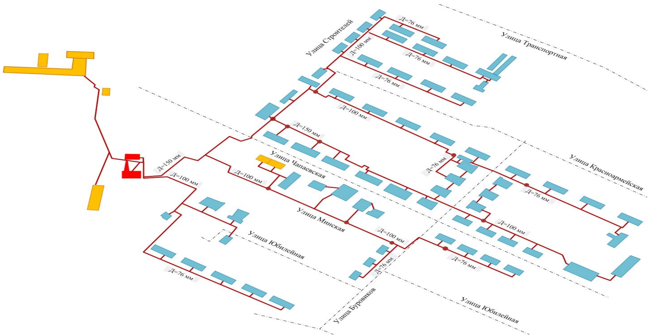
Рис. № 29 -Принципиальная схема ТС Котельной № 1 в селе Большая Глушица на улице Юбилейной-36 (ООО «Коммунальные технологии»)
