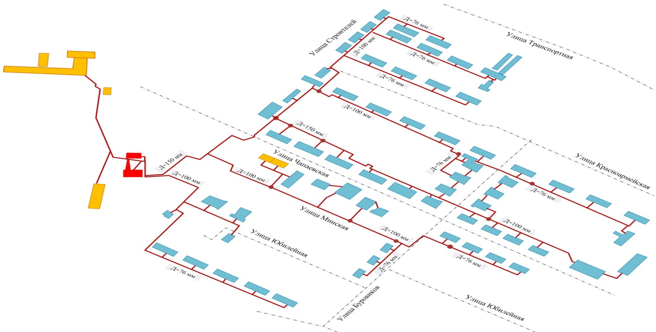
Рис. № 12 -Принципиальная схема ТС Котельной № 1 в селе Большая Глушица на улице Юбилейной-36 (ООО «Коммунальные технологии»)
