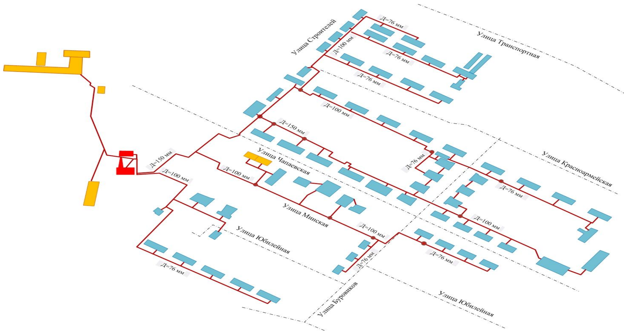
Рис. № 25 -Принципиальная схема ТС Котельной № 1 в селе Большая Глушица на улице Юбилейной-36
